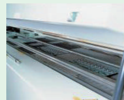
ハンダ・リフロー時の 基板のそり応力測定
